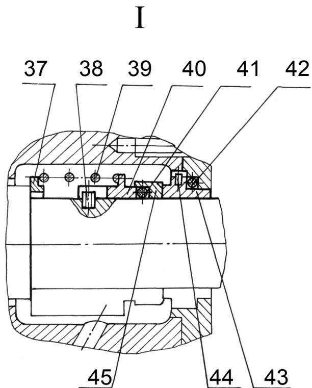
Рисунок А.3 - Уплотнение торцовое производства ОАО «Ливгидромаш»
