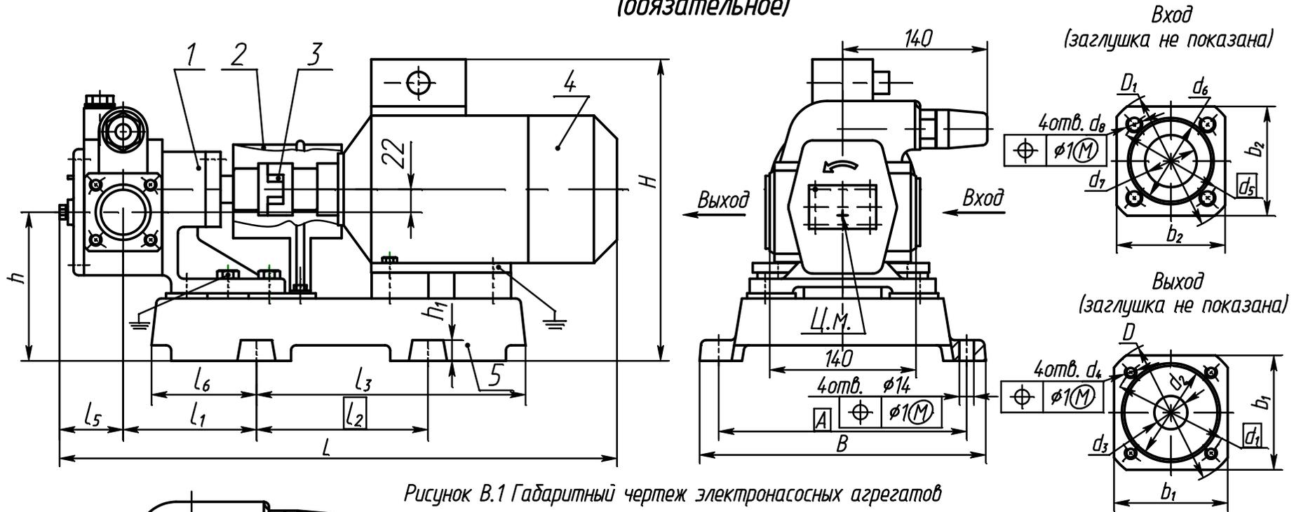
Рисунок В.1 Габаритный чертеж электронасосных агрегатов
