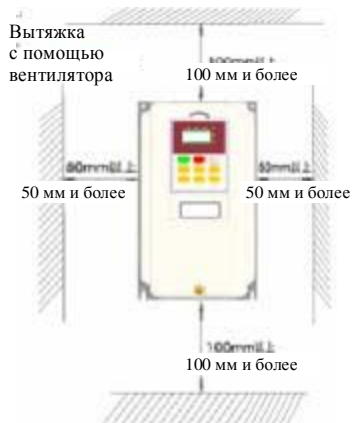
Рисунок 3-1. Пространство, требующееся для установки преобразователя
