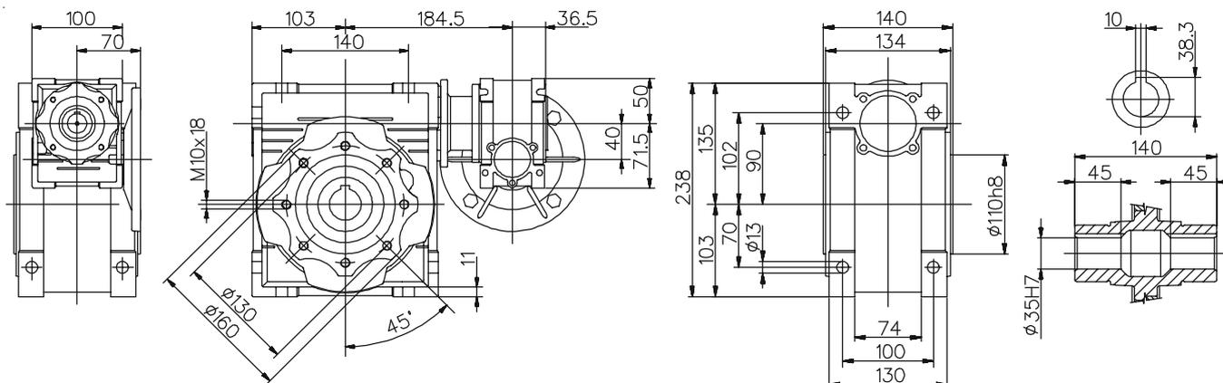
8 Габаритные и присоединительные размеры редукторов серии KPC
