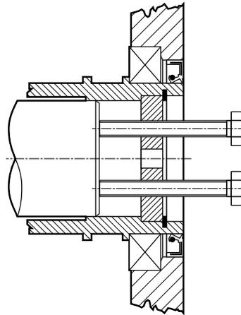
Le superfici di contatto dovranno essere pulite e trattate con adeguati protettivi prima del montaggio, onde scongiurare l'ossidazione e il conseguente bloccaggio delle parti.
